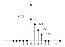
Por la propiedad de desplazamiento, Y[k] es la DFT de un desplazamiento circular de tres muestras a la derecha de la secuencia x[n].
