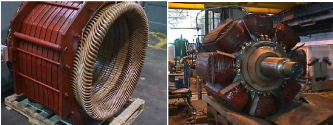
Figura 2: Estator y Rotor de Polos Salientes de una Máquina Sincrónica [2].
